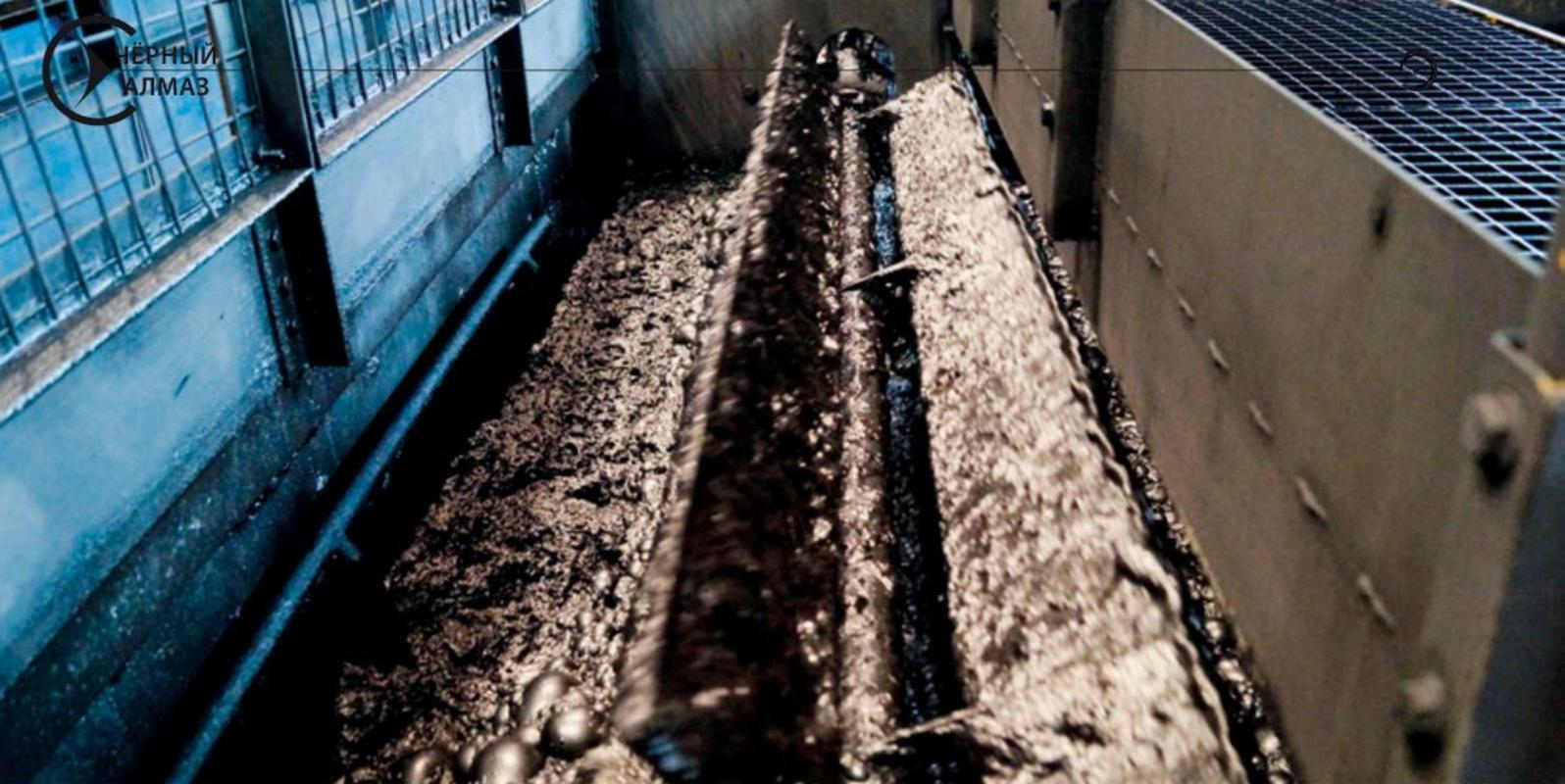
ских, пневмомеханических) идёт по всем узлам и агрегатам: от импеллера, разделяющих решеток, насосов подачи пульпы и воздуха до камер и их конструкций. Эффективность процесса (цена, экологическая и пожарная безопасность) зависит от реагентного режима.
