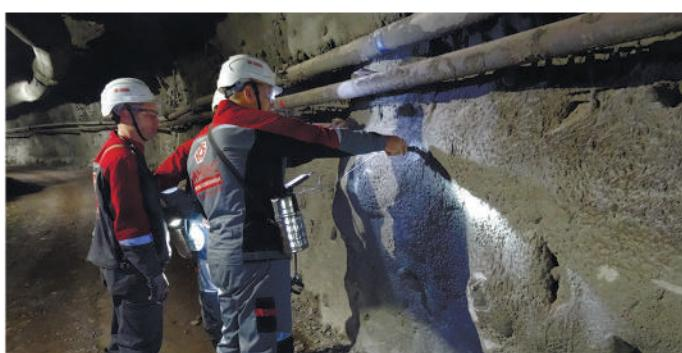
До сих пор «Норильский никель» использовал СЗА лишь в качестве временного вида крепи в горно-подготовительных и нарезных выработках и никогда в горно-капитальных. Основным видом крепи при установке в бортах и кровле оставались железобетонные и сталеполимерные анкеры и металлическая сетка. Главный недостаток этой технологии — низкая скорость: нужно ждать 12 часов, чтобы бетон набрал необходимую прочность.
