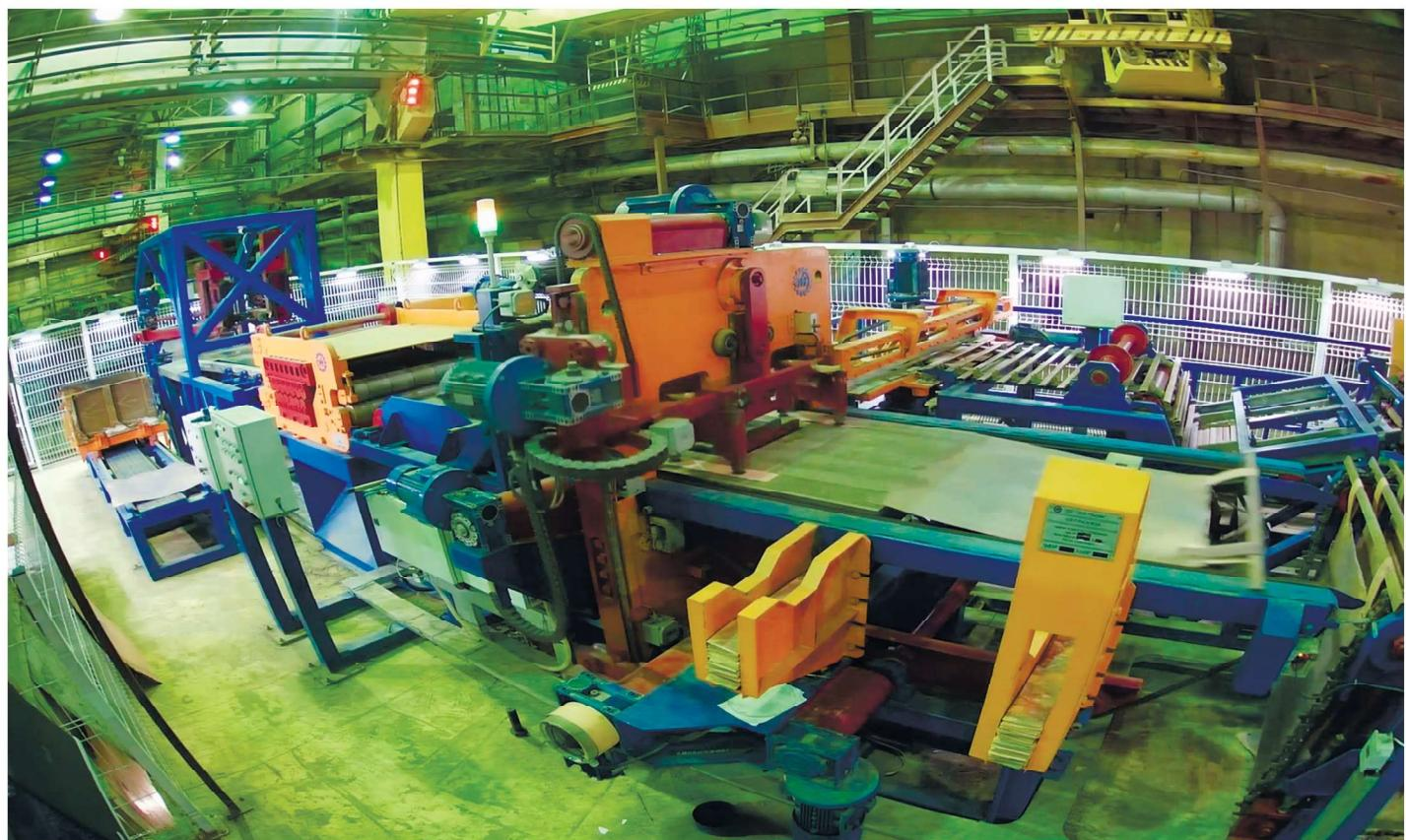
ЛАСО позволяет производить линейное перемещение компонентов, выполнять любые манипуляции с технологическими компонентами в двух, трех и четырех осях. В ней отсутствует гидравлическая система, что упрощает обслуживание. Технические решения по ограждению, освещению и блокировке рабочих механизмов исключают риски травматизма работников.
