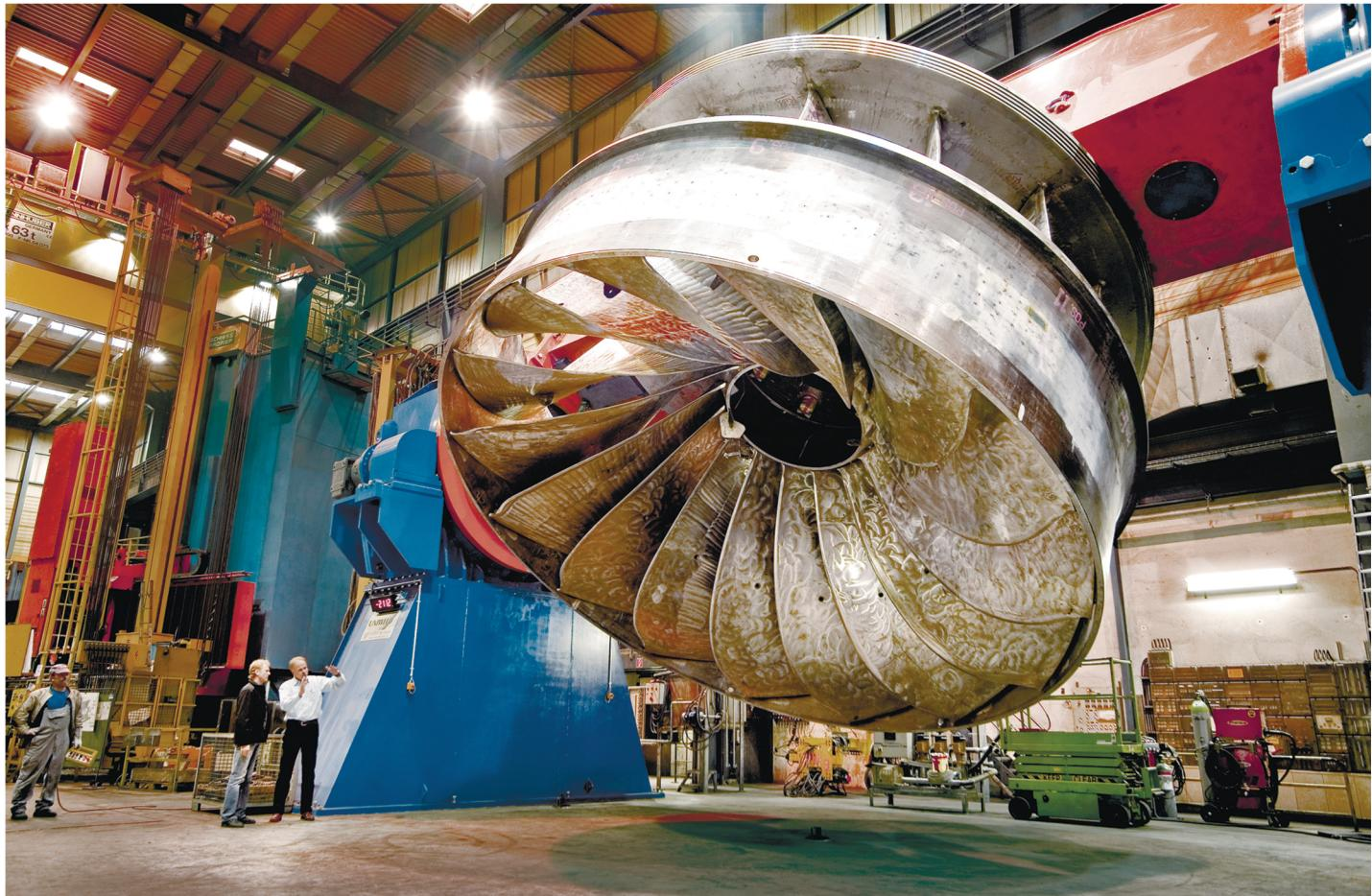
Турбина Фрэнсиса - внутренняя реакционная турбина, сочетающая в себе концепции радиального и осевого потока. Это самая распространенная на сегодняшний день водяная турбина со средним напором до 700 м и мощностью до 800 МВт на единицу.
