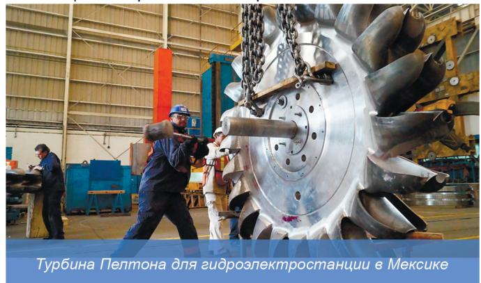
Турбина Пелтона для гидроэлектростанции в Мексике
