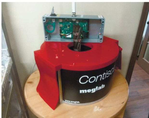
Устройство диагностики тросов подъемной машины Meglab
