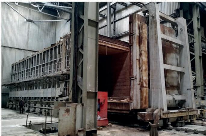
Подовая печь, предназначенная для обжига, отпуска и закалки изделий, имеет уникальные характеристики. Так, максимальные габариты обрабатываемой детали могут достигать 5x5x22 метра и вес - до 300 тонн.
