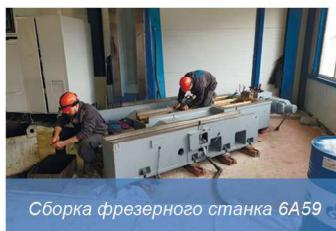
Сборка фрезерного станка 6А59
