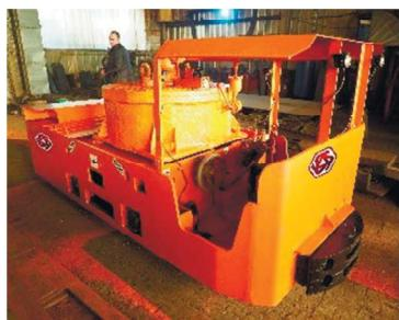
Инерционный локомотив (гировоз) предназначен для передвижения вагонеток по откаточным горизонтам рудников, опасных по газу и пыли. Его уникальность заключается в абсолютной безопасности — локомотив приводится в движение
