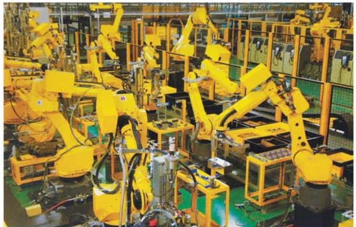
Автоматическая линия по сборке роботов (FANUC)
